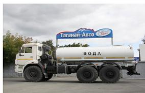
**Автоцистерна для технической воды АЦВ-10 на шасси Камаз 5350-66(D5)**
