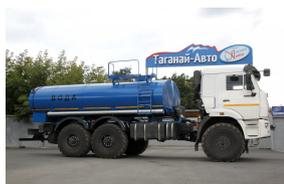
**Автоцистерна для питьевой воды АЦПТ-10 на шасси Камаз 43118-50 (с подогревом емкости)**
