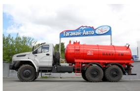
**Ассенизаторская машина КО-505 объемом 10 м3 на шасси Урал NEXT 4320-74Е5**
