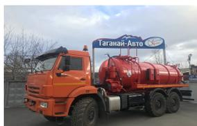
**Автоцистерна вакуумная АКН-10-ОД на шасси Камаз 43118-50 (насос КО-505)**
